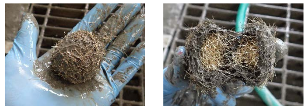
a) ファイバーボールの外観 b) ファイバーボールの内部 写真-2 ファイバーボール
