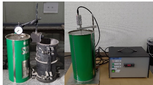
図-5 沈降量試験 ダイヤルゲージ(左) ディプスゲージ(右)
