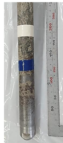
写真-1 挿入深さの指示マーク
