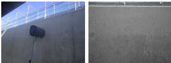
写真-16 天端より170mm 薄い縞模様箇所での透気試験
