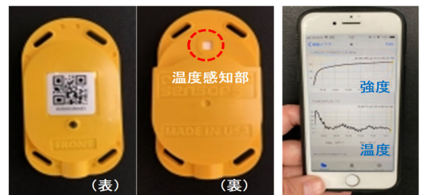
写真-1 センサ(無線)の外観および計測画面
