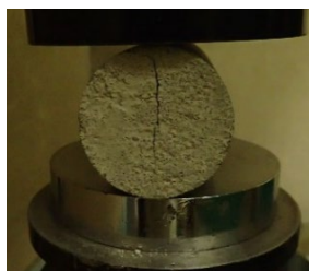
写真-3 通水試験【その1】ひび割れ導入状況
