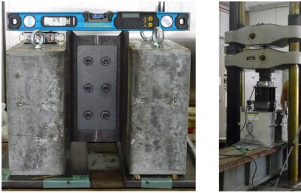
写真-2 試験体および載荷状況
