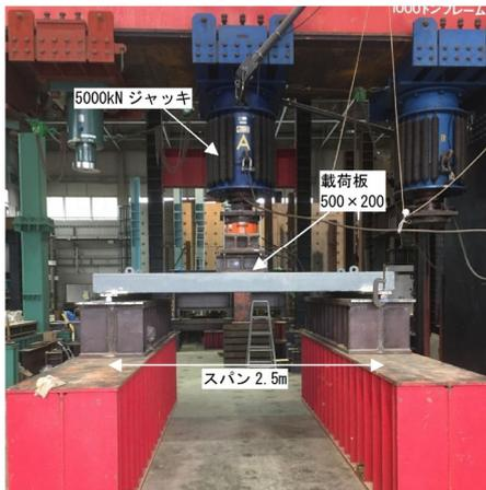
写真-3 静的載荷試験体設置状況
