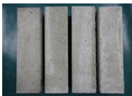
写真-2 屋外暴露5年における供試体の外観
