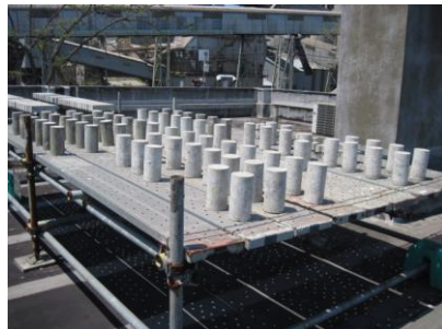
写真-1 暴露場の景観及び暴露状況
