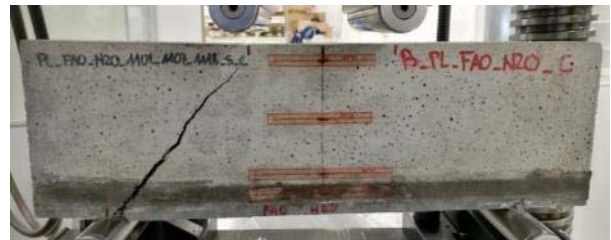
図-7 せん断破壊した試験体 (FA0 N20 シリーズ)
