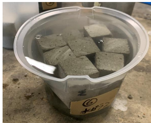
図-3 浸漬補修の様子
