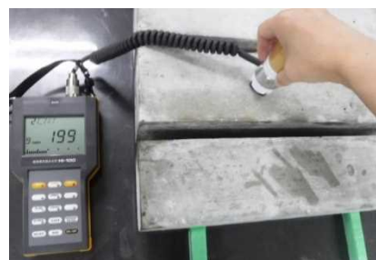
写真-3 電気抵抗式的水分計を用いた測定状況
