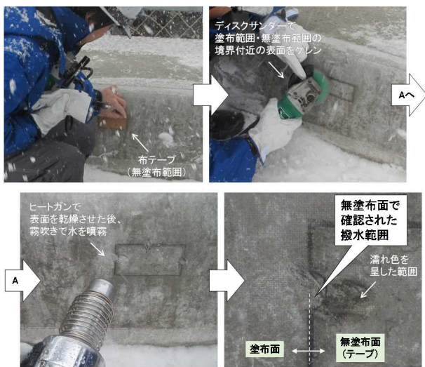
写真-6 試験状況 (道路橋 B の地覆)
