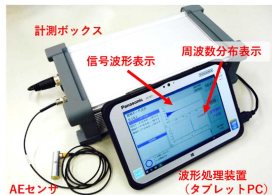
図-2 AE 打音検査装置の外観
