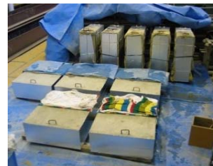
(d) 床部材 (手前) と柱部材 (奥) の湿潤養生・気中養生
