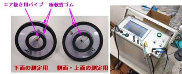
(a) ダブルチャンバー部 (b) 計測部 写真-1 ダブルチャンバー式加圧透水・透気試験機(WAPP)法の試験装置 4)
