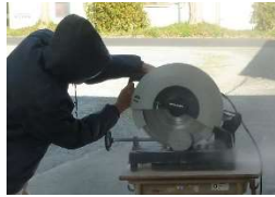
④供試体の切断
