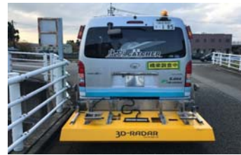
写真-5 車載式電磁波レーダ
