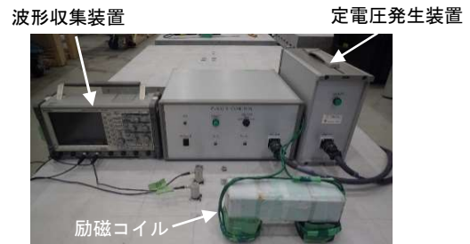
図-5 計測装置外観
