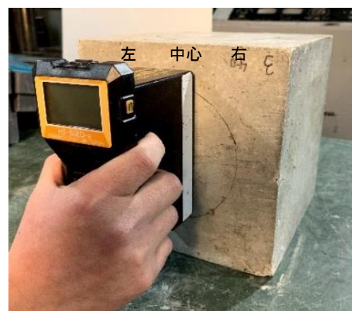
写真-4 表面含水率測定時の様子
