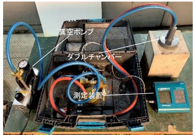
写真-3 Torrent法での測定の様子
