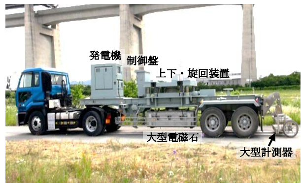
図-2 大型電磁石搭載型牽引車両(検査車両)
