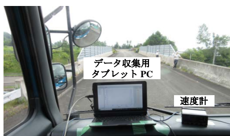
図-15 実橋梁（旧虻田洞爺湖 IC）での走行状況
