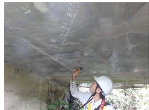
(b) 橋梁下面(補修面)での弾性波入力状況 写真-1 今回の試験での測定状況図
