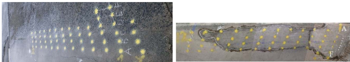
写真-4 測定点の設定状況
