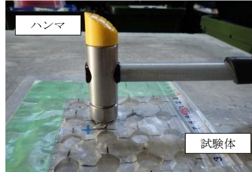
写真-3 打撃試験の測定状況
