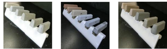
写真-1. 高温時の形状安定性試験の結果の例 左からセメントモルタル, FA100%GP, FA80-BFS20%GP 加熱温度並び順, 1000, 800, 600, 400, 200, 未加熱)
