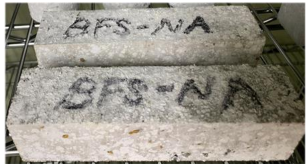
写真-2 BFS_NAの試験体に発生した白華
