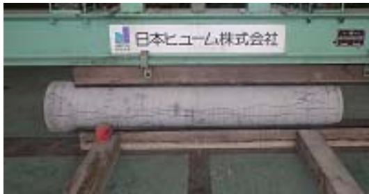
写真一4 外圧試験とひび割れの発生状況
