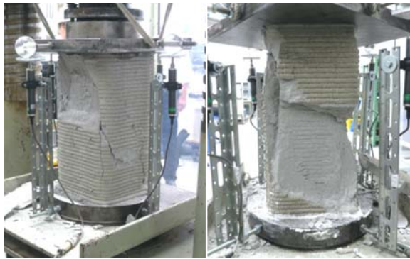
写真-2 試験体の破壊状況
