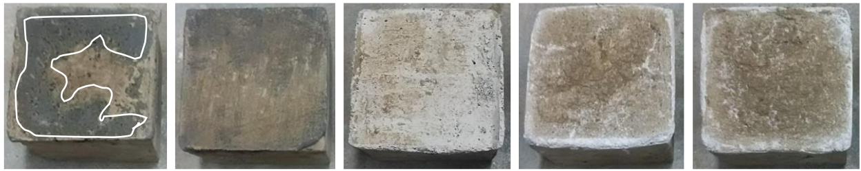
No.1 セメントモルタル No.2 タイル用モルタル No.3 マグモルタル No.4 消石灰モルタル No.5 膨張材モルタル ※囲み枠：目地部の付着範囲を示す，セメントモルタル以外の目地あり版築ブロックでは付着はほとんど確認できず 写真-3 曲げ強度試験後の目地あり版築ブロック破壊断面
