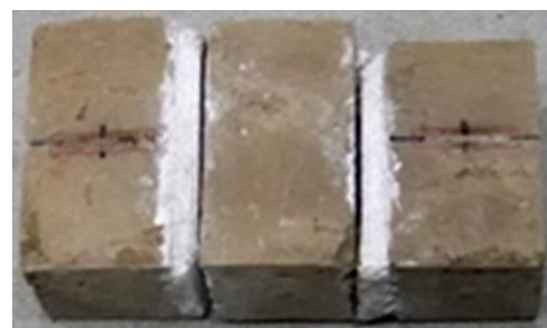
拘束あり：両端の版築ブロックが外れる 写真-4 二面せん断試験・破壊状況の例
