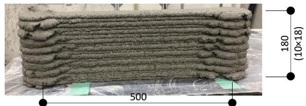
写真-3 積層試験体
