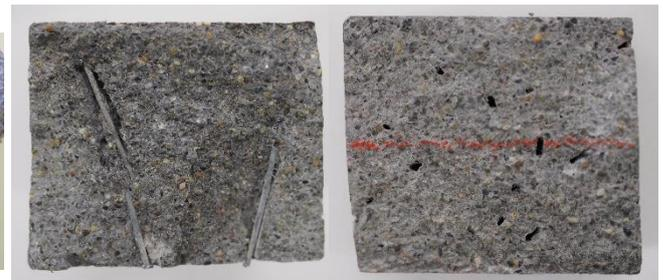
(a) 曲げ(a)の破断面 (b) 曲げ(b)の破断面
