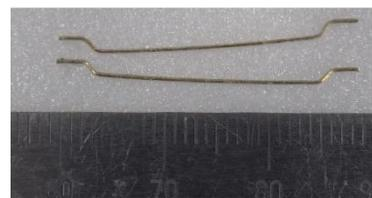
写真-1 両端フック型鋼繊維 (HDR)
