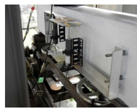
写真-1 試験区間に おける相対変位の計測 方法
