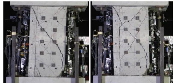
図-6 最終サイクルピーク時の破壊状況
