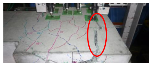
写真-1 標準試験体の変形角 4.0%時における上面の 様子
