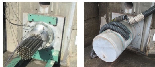
写真-1 ロードセルの設置状況と外観
