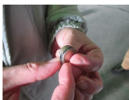
写真-4 ひずみゲージを密閉していた蓋
