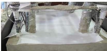
写真-1 打継ぎ面におけるコンクリート間の付着抑制
