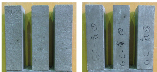
(a) GC 気中 (左:打込み面, 右:側面 0 サイクル)
