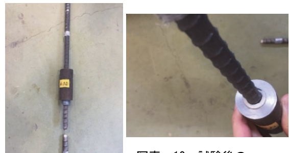
写真-9 母材破断の様子 (4d)
