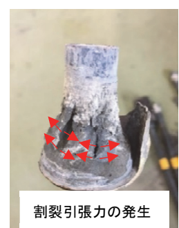
写真-6 破壊の様子 (追加養生後)
