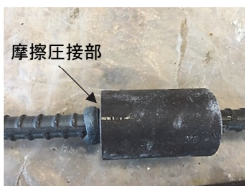
写真-1 モルタル充填 継手の外観
