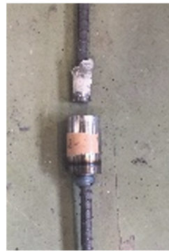
写真-3 引抜き破壊
