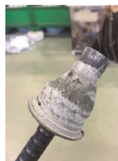
写真-5 破壊の様子 (追加養生前)
