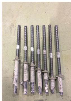
写真-8 破壊の様子 (右から 4d~10d)
