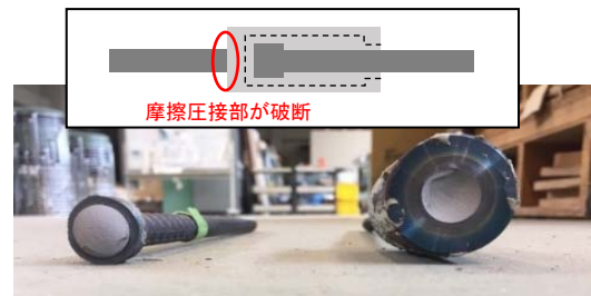
写真-2 スリーブに SS400 を用いた供試体における摩擦圧接部の破断状況
