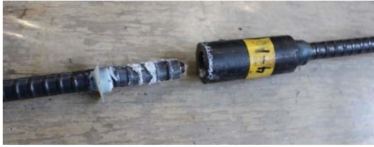
写真-3 引抜き破壊状況 (ケース 1)
