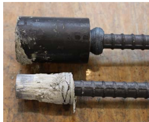
写真-4 引抜き破壊状況 (ケース 7)
