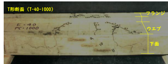
写真-1 曲げ載荷試験後の供試体 (T-40-1000)
