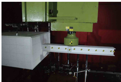
写真-2 衝撃荷重載荷実験状況
