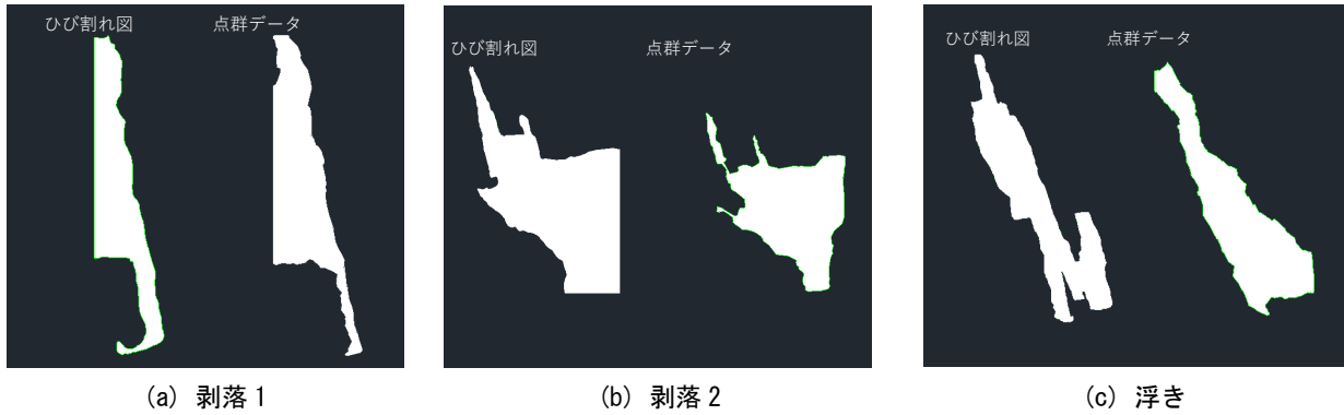
図-17 ひび割れ図と点群データの比較
