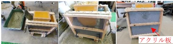
1)人力でコンクリート充填 2)コンクリートの自己充填 3)コンクリート充填完了 写真-6 早強コンクリート採用時の人力施工性確認
