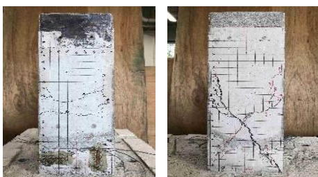
写真-4 曲げせん断破壊した(損傷度 III 相当)試験体
