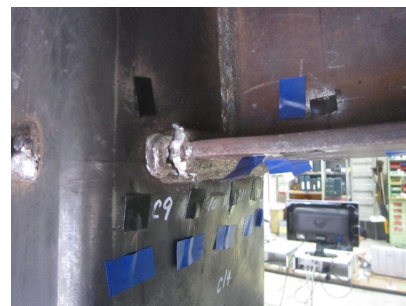
(b) 梁端隅肉溶接部の亀裂 (貫通梁直交方向)
