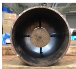
写真-1 試験体断面(グラウト充填前)
