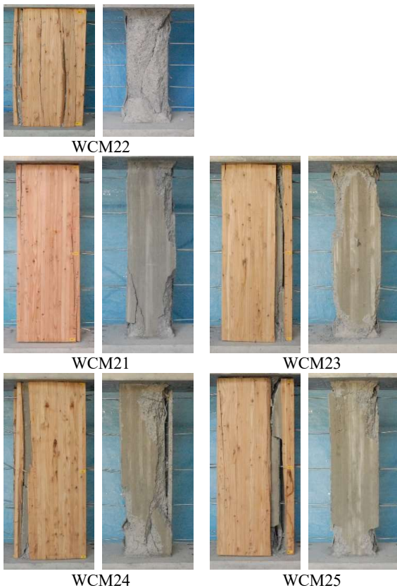
図-3 最終破壊状況(正面)
