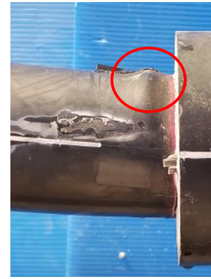
図-5 載荷後の鋼管(S-2.50)
