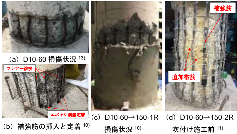
写真-1 これまでの実験による損傷状況と補修方法
