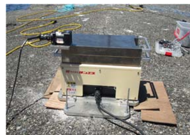
図-10 漁港施設防波堤の起振機設置状況
