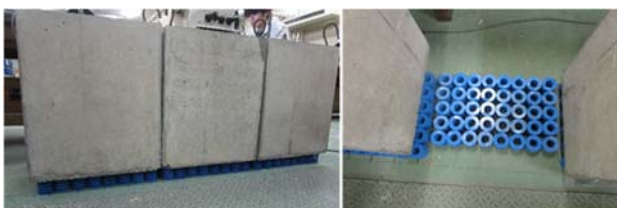
図-1 供試体（左）と圧縮ばね（右）の外観
