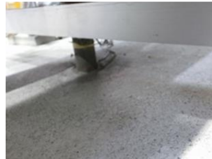
写真-3 PC 鋼棒 φ32 アンカー筋引張試験後のコンクリートブロック表面の状況
