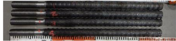
写真-3 使用したアンカー筋（ケース 1）
