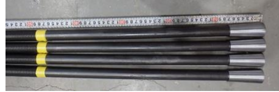
写真-4 使用したアンカー筋（ケース 2）
