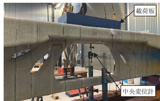
図-13 載荷試験状況
