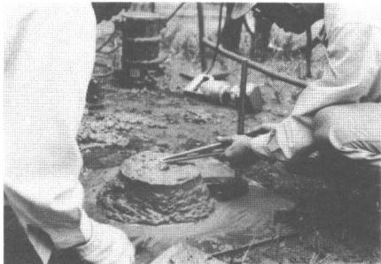
写真3 SFRCのスランプ試験結果
