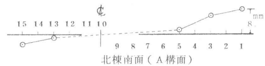
図10 屋根桁の水平変位
