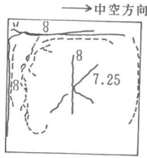
HS22の 図3 ひび割れ状態図
